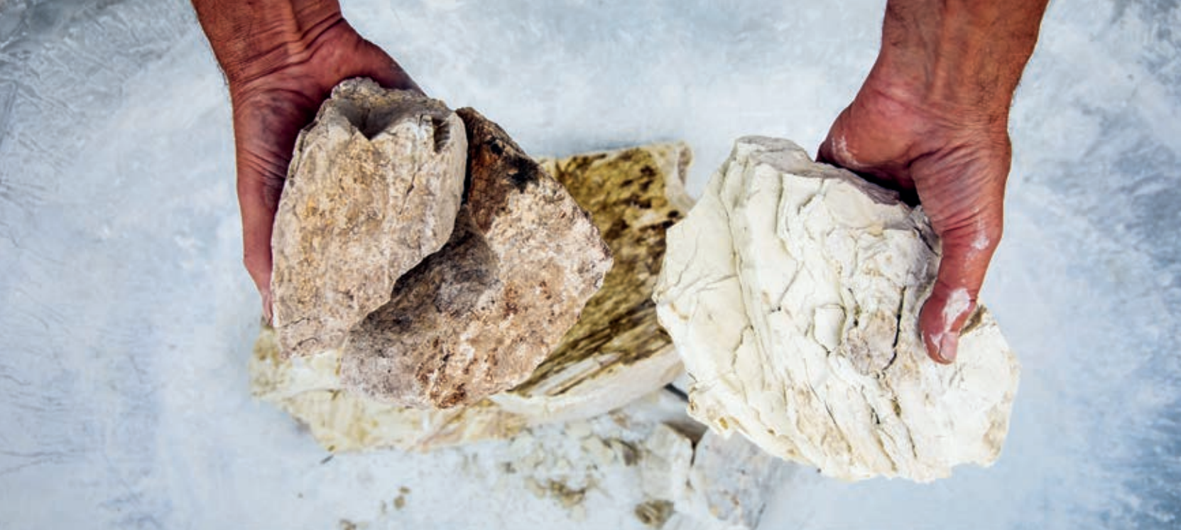
Kalkgestein (links) ist nach dem Brand weiss, brüchig und um ca. 50% leichter.
